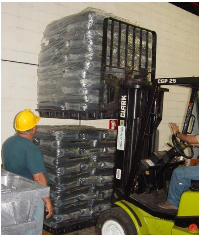
Paleta ligera, con diseño de cuatro entradas que facilita las maniobras de operación. Ideal para almacenaje en apilamiento (paleta para piso).
